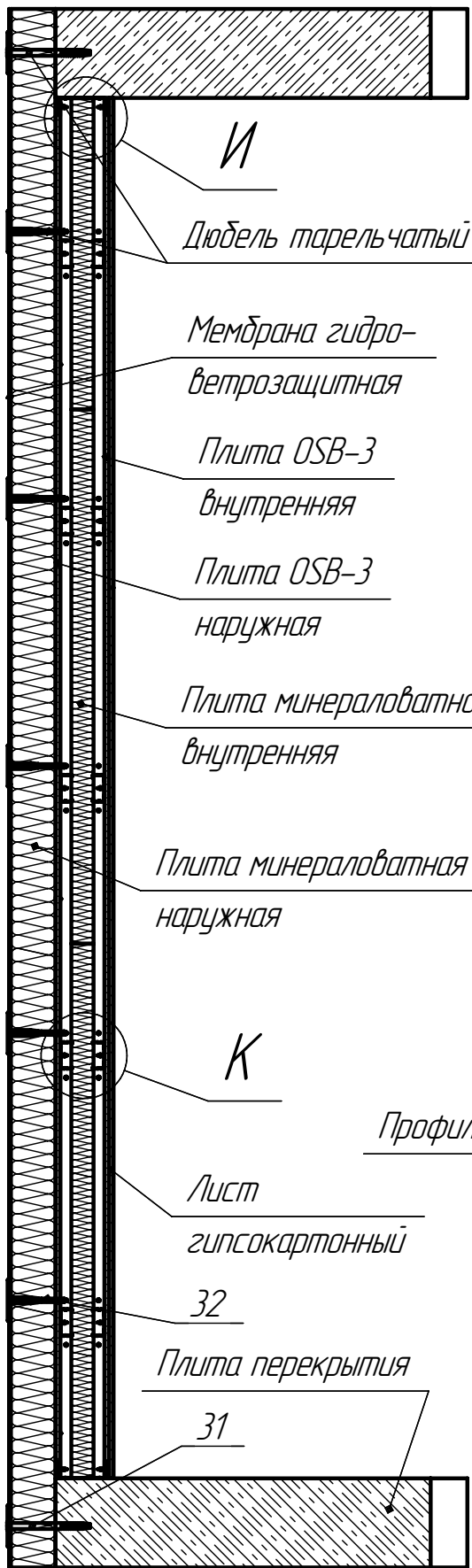
Рис. 8.2 Вертикальный разрез каркасной стены
