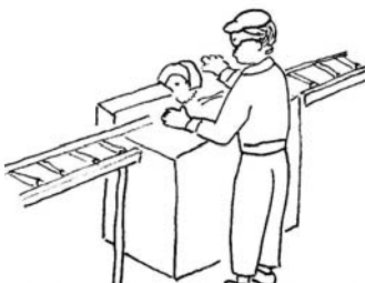
8. Резка алюминиевых экструдированных деталей
